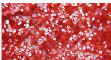
Fibre viscosa corte floccate
