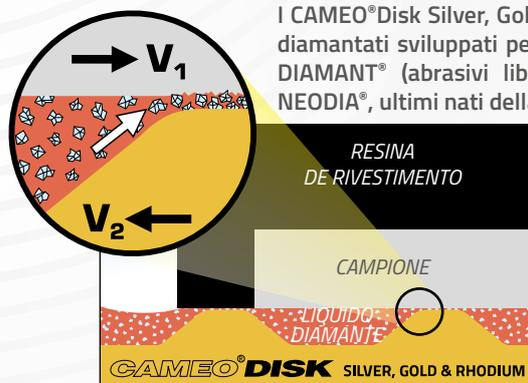
I CAMEO® Disk Silver, Gold & Rhodium sono dischi di pre-lucidatura non diamantati sviluppati per essere utilizzati con gli esclusivi abrasivi Bio DIAMANT® (abrasivi liberi). Combinati all'ampia gamma di abrasivi NEODIA®, ultimi nati della gamma Bio DIAMANT®, permettono di trattare ogni tipo di materiale.
