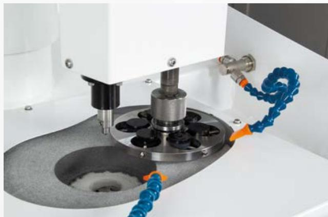
La levigatura e la prelucidatura sono fasi essenziali nella preparazione di un campione metallografico. È la qualità di queste fasi che condiziona e ottimizza il resto del processo. Al termine della fase di rettifica, l'aspetto del campione deve essere uniforme e omogeneo, senza variazioni di planarità o di materiale.
