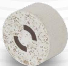
La resina 607 è una resina tricomponente a base di poliesteri modificato. Questa resina a presa rapida aderisce bene alle superfici metalliche.
