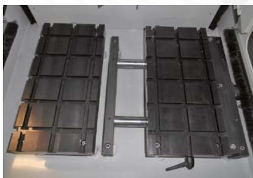
Tavola trasversale dell'asse X, corsa 120 mm
