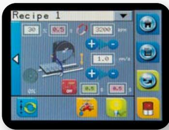
300 programmi possono essere salvati nella memoria interna, compreso posizionamento dell'inizio del taglio, velocità d'avanzamento, velocità di rotazione, tipo di taglio.
