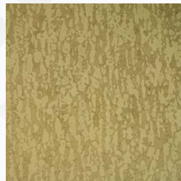
Titane TA6V attaqué par le réactif de Kroll
