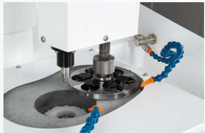
Prépolissage d'échantillons enrobés, montés sur porte-échantillon à pression centrale.
