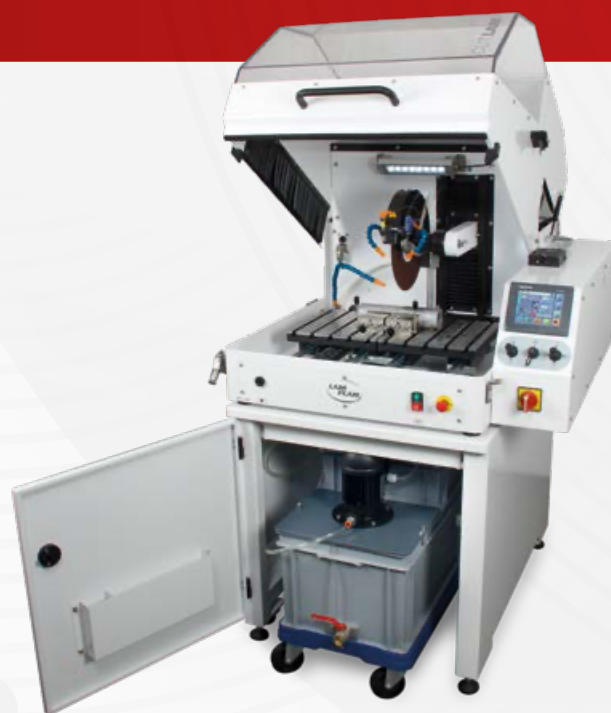
Meuble support avec système de recirculation (60 litres).
