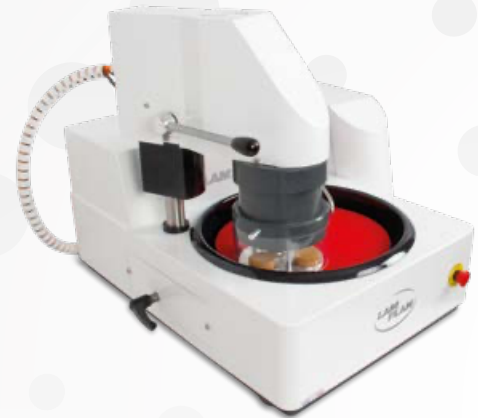
Tête motorisée à pression individuelle. Capacité : 3 échantillons du Ø 25,4 à 50 mm.
