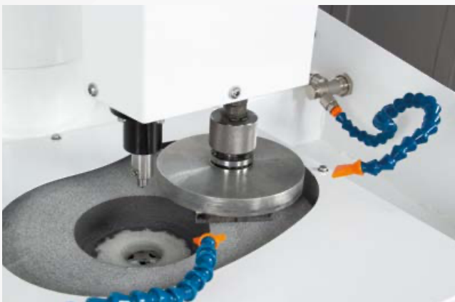
Große Rohproben zu schleifen.
