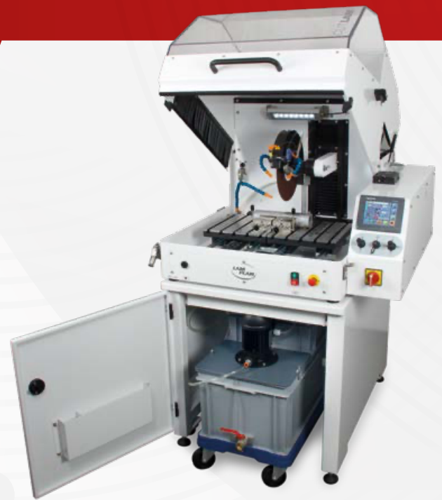
Schrank mit integriertem Umwälzsystem 60 Liter.
