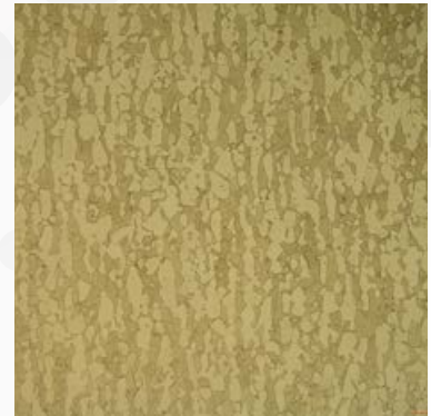
TA6V-Titan, das mit Kroll's Reagenz geätzt wird
