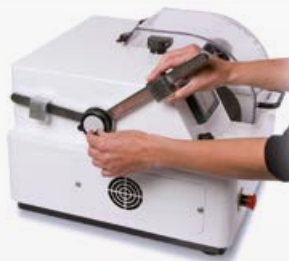
Manuelle mikrometrische Einstellung der Z-Achse.
