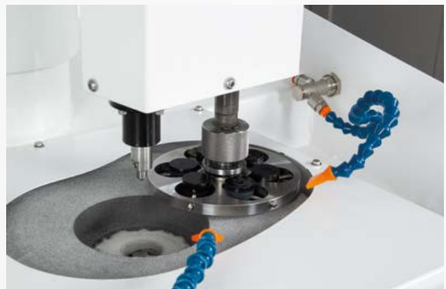
Teile auf einem Zentraldruck-Probenhalter zu schleifen
