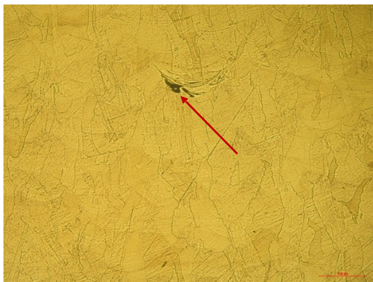
Défaut micro-structurel (flèche rouge) résultant d'une mauvaise fusion des couches dans un acier fabriqué de manière additive en alliage 316L.
