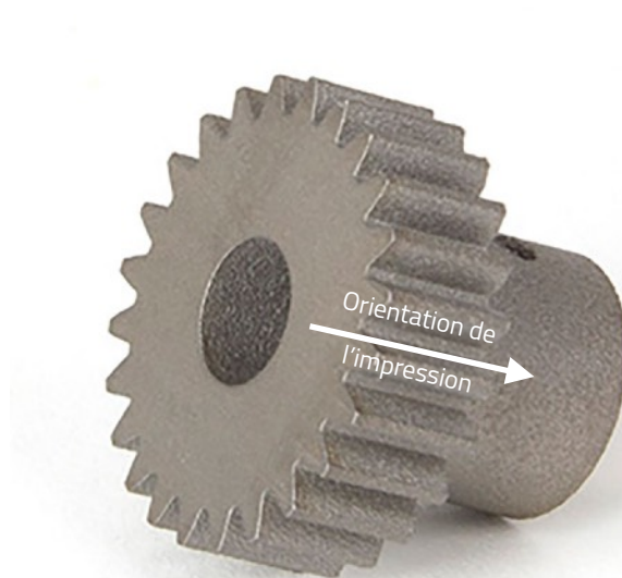
Pièce en acier inoxydable austénitique 316L fabriquée par DMLS (Direct Metal Laser Sintering).
