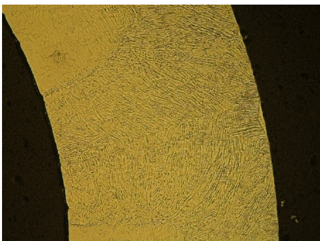
Microstructure en acier inoxydable 316L laminé et soudé (légèrement attaquée avec du réactif de Kalling)
