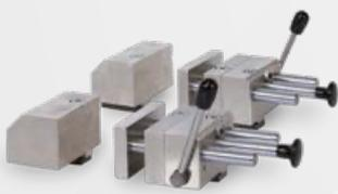
Double étaux à serrage rapide (droite et gauche de la meule de tronçonnage). 2 x 2 mors, sans semelle pour préserver une capacité maximale. Largeur des mors 80 mm Hauteur des mors 45 mm Vis de 12 mm incluses pour rainure en T. Levier à gauche et à droite. | 60 CT200 20  |              |     |     | ✓       | ✓   | ✓   | ✓   |
