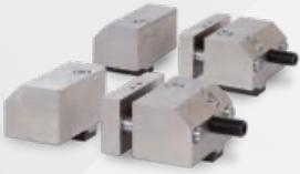
Double étaux à vis (à droite et à gauche de la meule de tronçonnage) 2 x 2 mors, sans semelle pour préserver une capacité maximale. Largeur des mors 80 mm Hauteur des mors 45 mm Vis de 12 mm incluses pour rainure en T.                                      | 60 CT200 40  |              |     |     | ✓       | ✓   | ✓   | ✓   |
