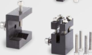
Porte-échantillons en V serrage par vis Ø 24 mm maxi                                                                                                                                                                                                              | 60 CTM03 20  | ✓            | ✓   |     |         |     |     |     |
