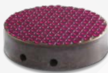
Polieren von Uhrenindustrieteile auf Plaketten montiert.
