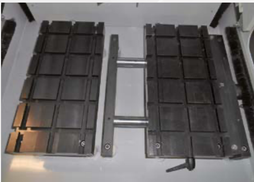
X-Achse Kreuztisch, Hub 120 mm
