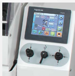
Posizionamento rapido con joystick. Schermo tattile con interfaccia grafica.
