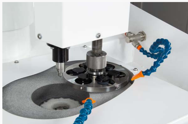
Prelucidatura di campioni rivestiti, montati su un porta campioni a pressione centrale.
